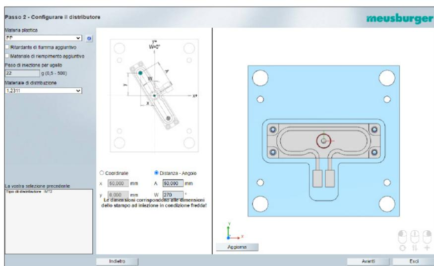
Come seconda cosa, viene inserito il tipo di materia plastica da lavorare e il peso del materiale del manufatto. Inoltre, a seconda del modello, può essere selezionato il tipo di acciaio necessario per il distributore.
