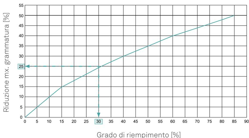
“Riduzione della grammatura di iniezione”. Esempio: 30% di contenuto di riempimento, 25% di grammatura di iniezione
